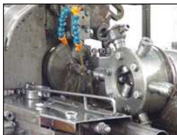
15. ábra Revolverautomata revolverfeje
