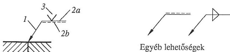
7.110. ábra. A rajzjel elhelyezése és a referenciavonal elemei 1 mutatóvonal; 2a referenciavonal (folytonos); 2b azonosítóvonal (szaggatott); 3 varrat jele
