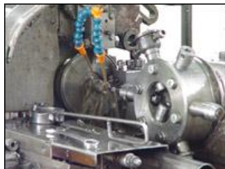
5.6. ábra - Revolverautomata revolverfeje (Forrás: [3]) 5.7. ábra - Revolverautomata revolverfeje (Forrás: [3])
