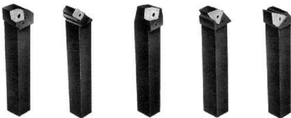
5.48. ábra - Forrasztott lapkás szerszámok (Forrás: [4])
