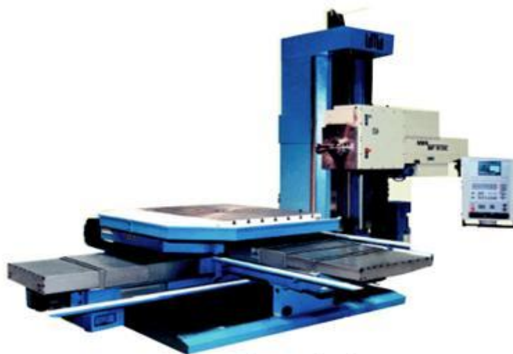
7.4. ábra - CNC fúró-marógép (Forrás: [4])
