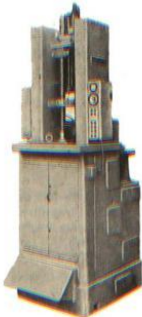
8.15. ábra - Függőleges belső üregelőgép (Forrás: [3])
