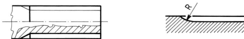
5.41. ábra: Szerszámkifutás bordástengelyen
